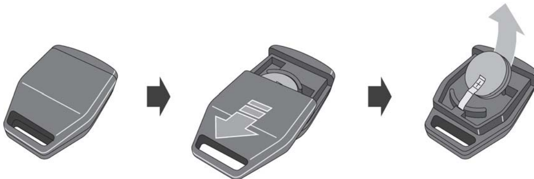
Fig. 5: Sostituzione delle batterie della chiave di accesso a infrarossi
