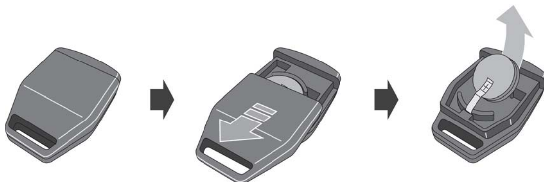
Fig. 5 : Remplacement des piles de la clé d'accès infrarouges
