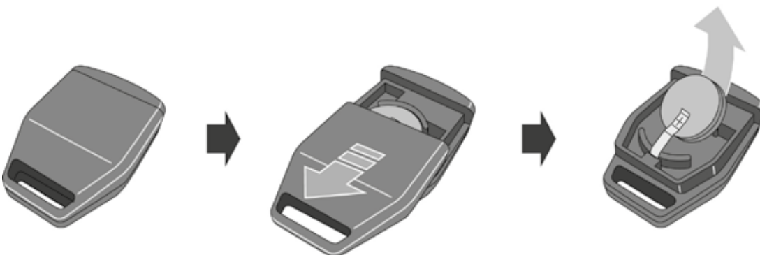
Afb. 6: Batterij infrarood-toegangssleutel vervangen
