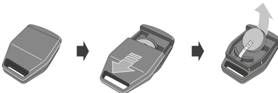
Fig. 6 : Changer les piles de la clé d'accès à infrarouges
