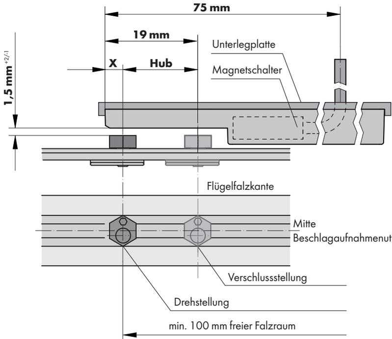
Beschlaghub zur Berechnung des Versatzes in Drehstellung
